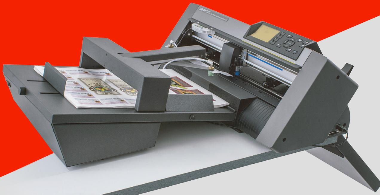
El Sistema **i-Mark** permite el corte de contorno sin operador en hojas adhesivas e impresiones digitales en cartulina gráfica, serigrafía y materiales de imprenta.
