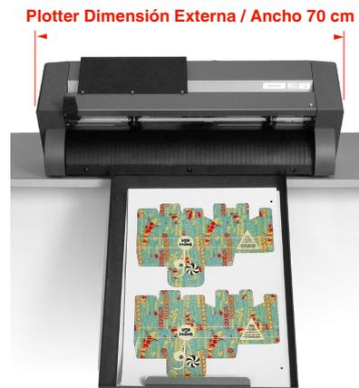
El sistema consta de tres partes independientes: Bandeja de entrada, plotter de corte y bandeja de salida. Estas tres piezas se ensamblan una encima de la otra y deben colocarse sobre una mesa, donde la bandeja de salida debe quedar colgada sobre el borde.
